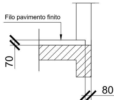
Per profondità fossa superiore a 1315 mm prevedere pilastri sotto ammortizzatori cabina di altezza pari a :
