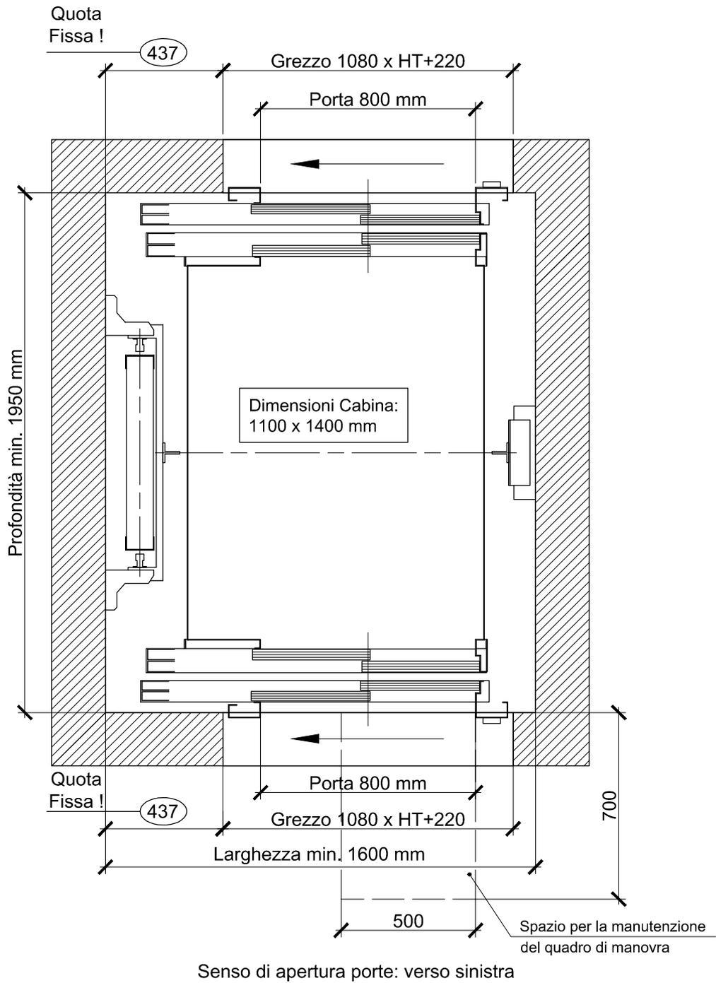
Con porte incassate di 50 mm : VANO MINIMO 1850 mm
