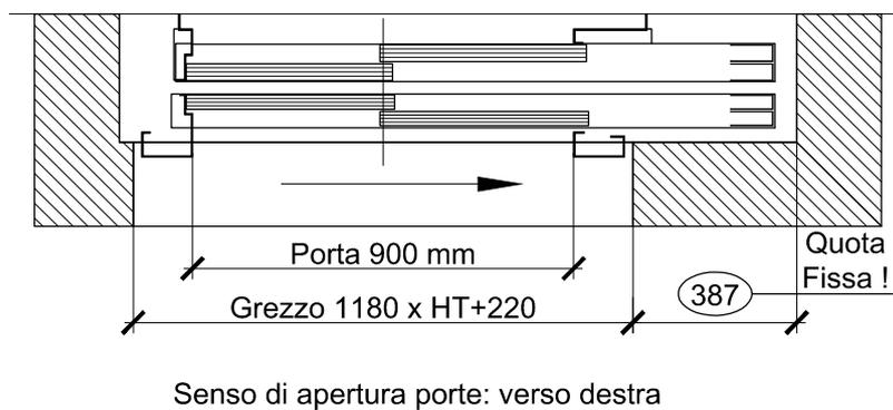
Con porte incassate di 40 mm : VANO MINIMO 1700 mm
