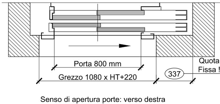
Con porte incassate di 40 mm : VANO MINIMO 1550 mm
